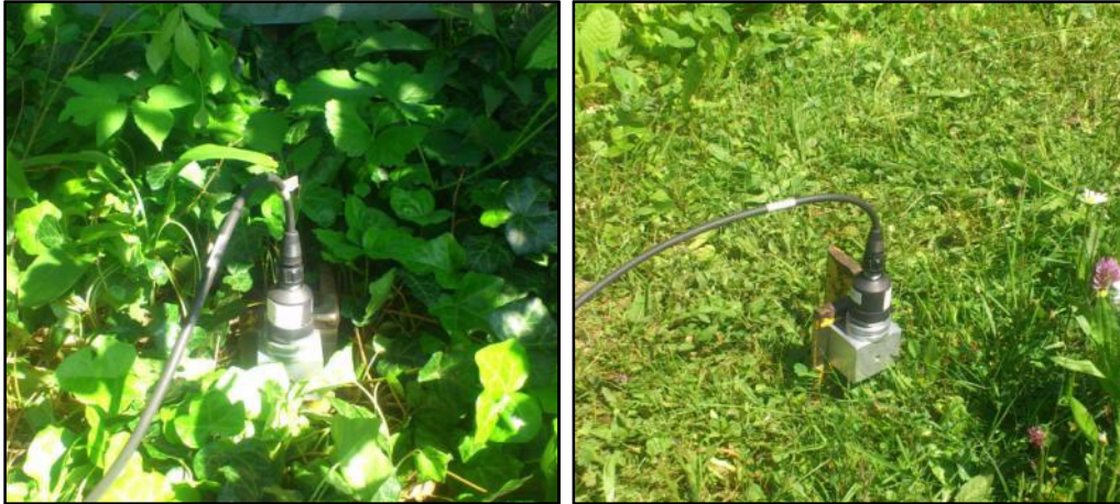
Abbildung 1.2- KS-Aufnehmer MpG5 (z) bei 8 m von nächstliegender Gleisachse (links), Mp G4 (z) 5m vorm Haus (rechts)
