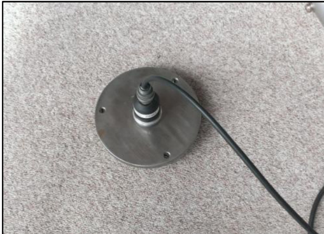
Abbildung 2.3- KS-Aufnehmer MpG1 (z) auf der Decke über 1.OG
