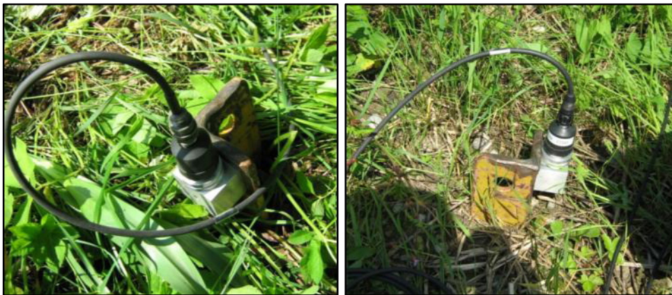
Abbildung 4.3- KS-Aufnehmer MpG7 (z) (links) bei 13m von nächstliegender Gleisachse, MpG4 (z) vorm Haus (rechts)
