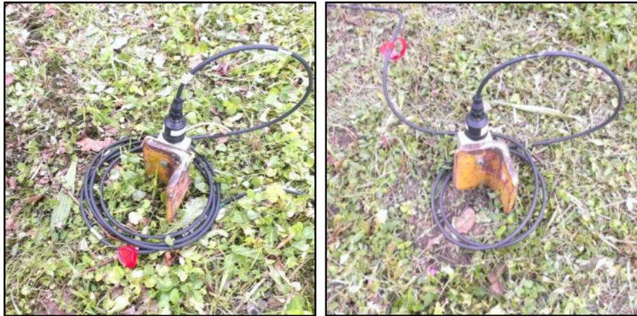
Abbildung 2.2- KS-Aufnehmer MpG5 (z) bei 19 m von nächstliegender Gleisachse (links), Mp G4 (z) 4m vorm Haus (rechts)
