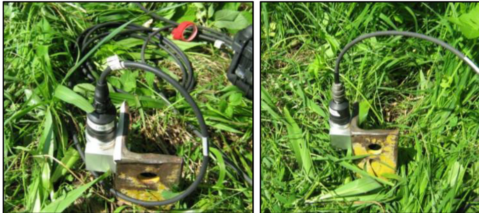
Abbildung 4.2- KS-Aufnehmer MpG5 (z) (links) und MpG6 (z) (rechts) bei 13m von nächstliegender Gleisachse
