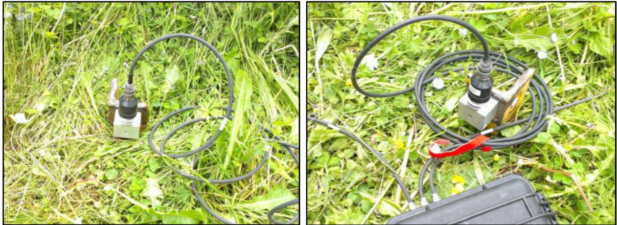
Abbildung 3.2- KS-Aufnehmer MpF1 (z) (links) und MpF2 (z) (rechts) bei 16 m von nächstliegender Gleisachse
