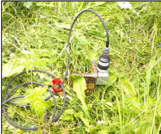
Abbildung 3.3- KS-Aufnehmer MpF3 (z) bei 16 m von nächstliegender Gleisachse
