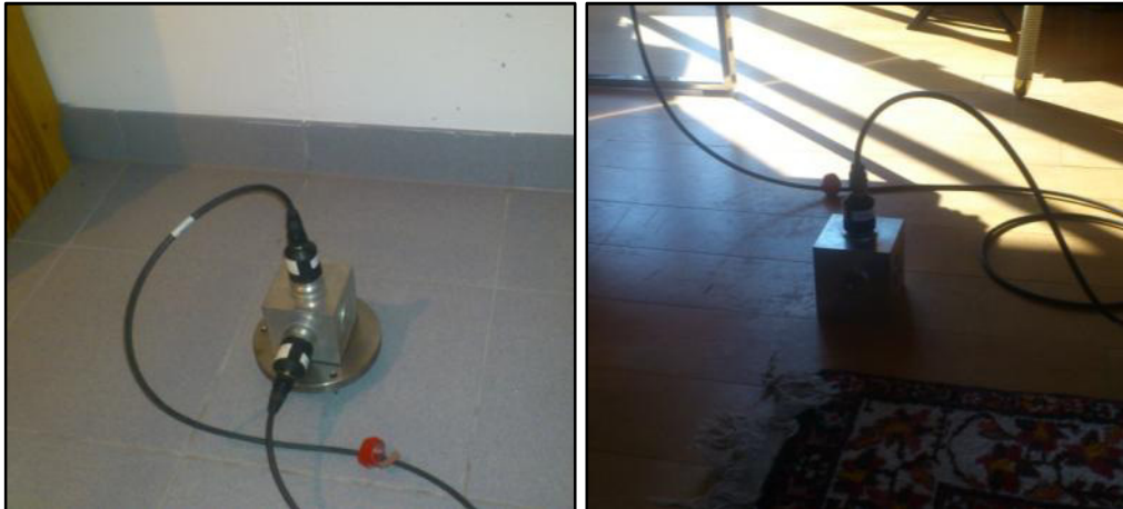
Abbildung 1.3- KS-Aufnehmer MpG3 (y) und MpG2 (z) im Fundamentbereich (links), MpG1 (z) auf der Decke über EG (rechts)
