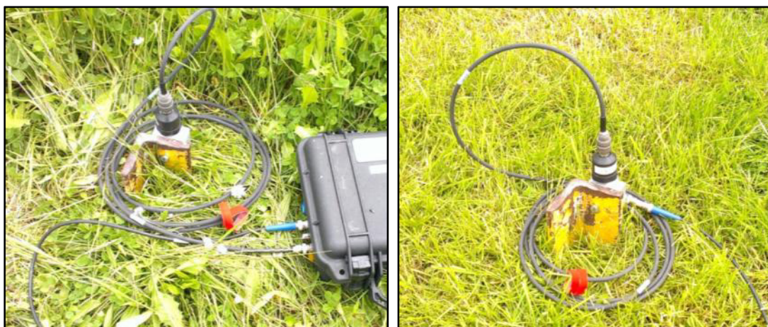
Abbildung 3.4- KS-Aufnehmer MpF4 (z) bei 32 m (links) und MpF5 (z) bei 64m von nächstliegender Gleisachse
