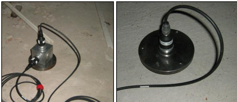
Abbildung 4.4- KS-Aufnehmer MpG3 (y) und MpG2 (z) im Fundamentbereich (links), MpG1 (z) auf der Decke über EG (rechts)
